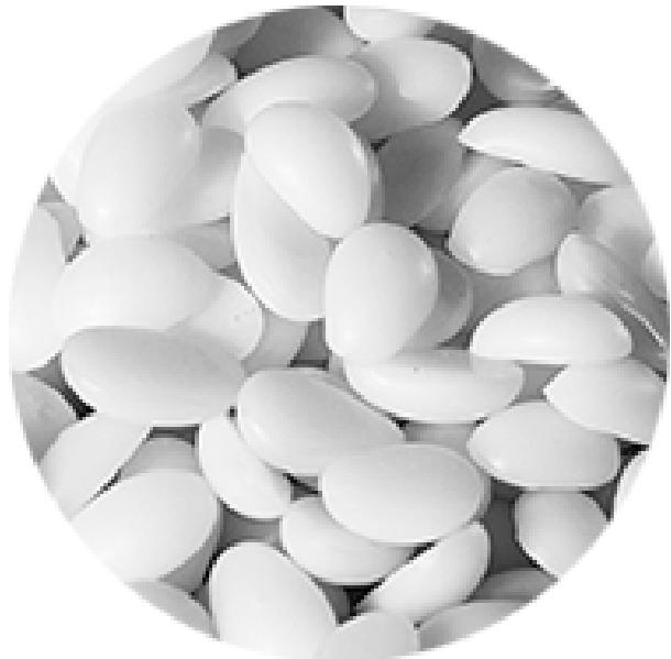
Полиэтиленовый воск неокисленный, неполярный, низкой вязкости.
